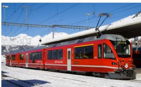
2 Szwajcaria, Kolej Retycka 1000mm 100 km/h (serw.) 139 km/h (test)
